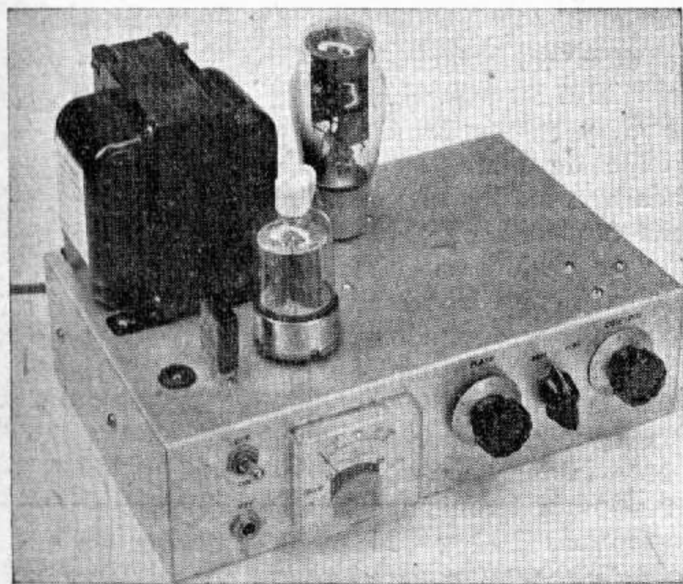
Fig. 6-39. — Esta vista del transmisor de 50 watts muestra la disposición del panel y la distribución de los componentes sobre el chasis. El cristal está entre la 6146 y la arandela de goma que sostiene la lamparita I_1 . Detrás de la 6146 está el transformador de alimentación y a la derecha de éste la válvula rectificadora.
