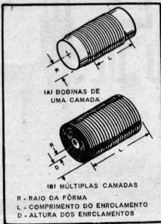
FIG. 1 — Como são medidas as dimensões das bobinas de camada singela e de múltiplas camadas.
