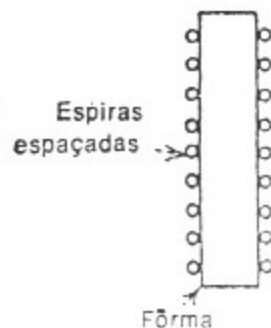
FIG. 6 — Reator de R.F. para frequências mais altas (acima de 10 MHz).
